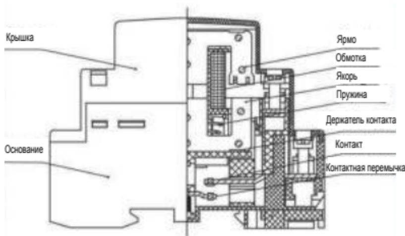
Рисунок 1. Основные элементы конструкции контактора
